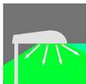
Una parte degli apparecchi di illuminazione esistenti (una parte di quelli stradali con vetro di chiusura piano ed alcuni proiettori) di installazione più recente, sono invece risultati adeguati, presentando buone condizioni di conservazione, schermo di chiusura piano (ottica cut-off) ed elevati rendimenti ottici (ottiche di recente costruzione) ed installati correttamente (inclinazione nulla rispetto al piano stradale).
